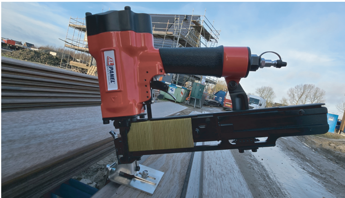
Afbeelding 2: Nietpistool met opzetstuk ontwikkeld door XL-Panel
