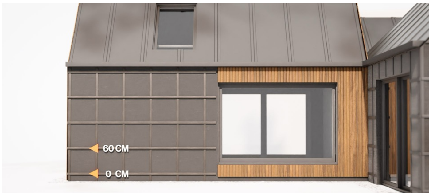
Afbeelding 5: Regelafstand om gevelbekleding tegen te monteren
