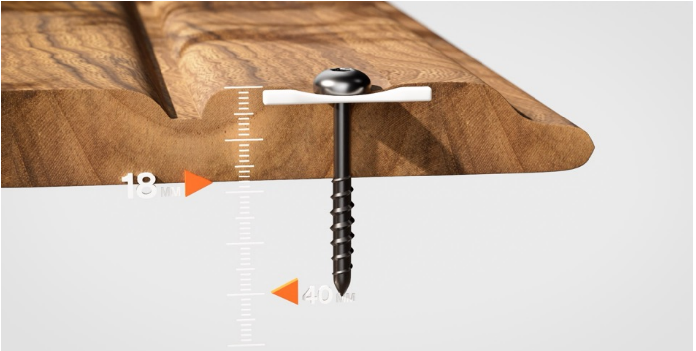
Afbeelding 7: Schiet of schroef bevestigingsmaterialen niet door het oppervlak van het hout om intrekend water te voorkomen
