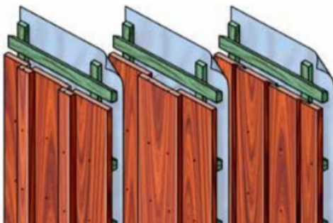
Afbeelding 4 - Verticale gevelbekleding V.I.n.r. opdekwerk, opdekwerk en rabat met halfhoutse overlap (channelsiding).
